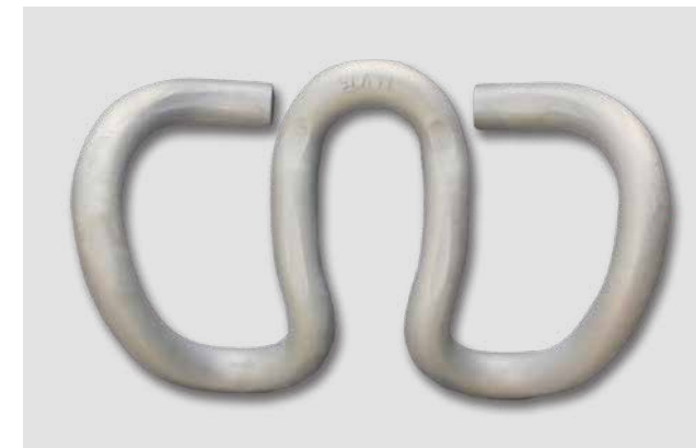
Nach 1440 h im Salzsprühtest gemäß ISO 9227 NSS.
