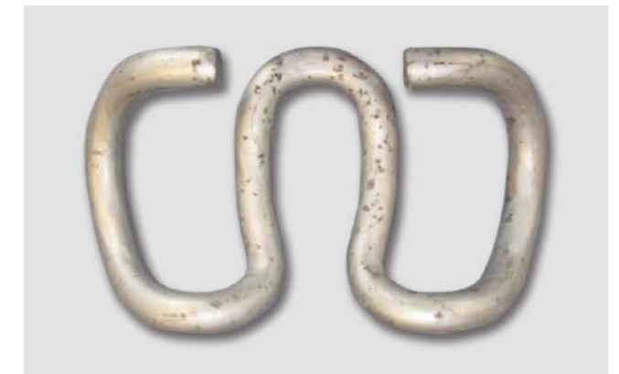
Nach 1440 h im Salzsprühtest gemäß ISO 9227 NSS mit vorsätzlicher Schichtverletzung zur Verdeutlichung des kathodischen Korrosionsschutzes.
